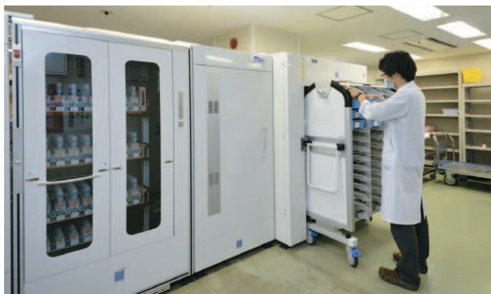
2014年7月に導入した注射薬自動払出装置。機械化を進めることで、医師や患者さんとのコミュニケーションの時間を増やす狙いがある。
