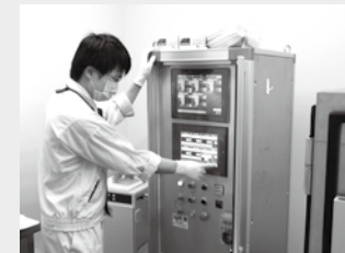
◀ 打錠機を用いて錠剤を試作しているところです。工場へのスケールアップに向けて、まずは開発センター内で製造条件の検討を行います。
